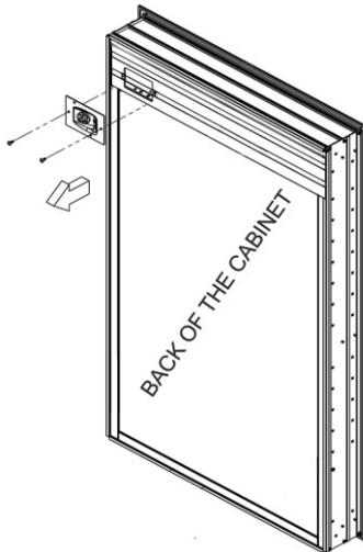
\*Le support de fil est situé dans le coin supérieur droit de l'armoire vu de l'avant\*
