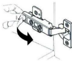
Para retirar la bisagra de la placa de montaje:
