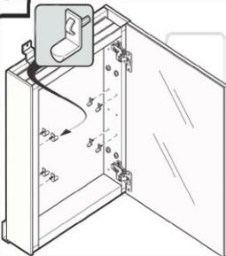
Insérez les supports d'étrangère transparents dans les clips de la tablette dans les trous situés sur les côtés du meuble.
