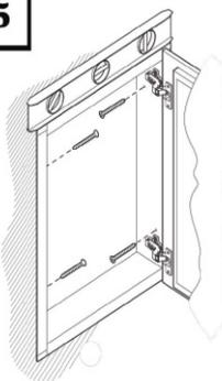
Nivele, después asegure el gabinete con las pijas a través de los orificios sobre el marco.
