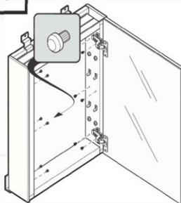
Insérez les bouchons transparents dans les trous restants / inutilisés de l'armoire.
