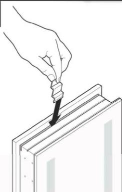
Faites glisser les supports supérieurs dans le canal supérieur de l'armoire.
