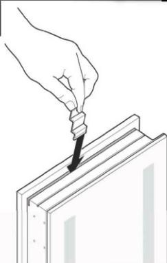
Deslice los soportes superiores dentro del canal superior del gabinete.
