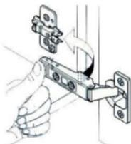
Para fijar la bisagra a la placa de montaje:
