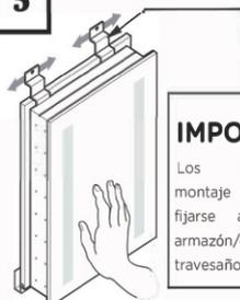
Puede deslizar los soportes superiores hacia la izquierda o derecha para conseguir la posición deseada.
