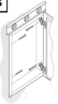
Nivelez, ensuite sécurisez l'armoire avec les vis avec les vis à travers les trous de montage dans les goujons de cadrage
